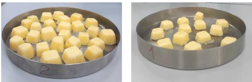
Рисунок 2. Замороженные образцы А, В, С кубиков йогурта толщиной: 10 мм, 15 мм, 20 мм перед проведением процесса сублимационной сушки
