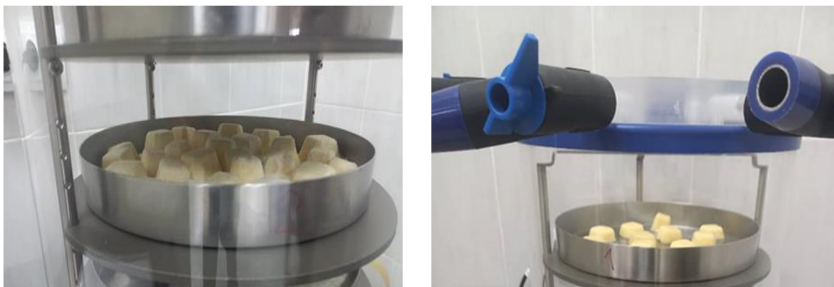
Рисунок 3. Процесс сублимационной сушки в сублимационной сушилке „Zirbus”
