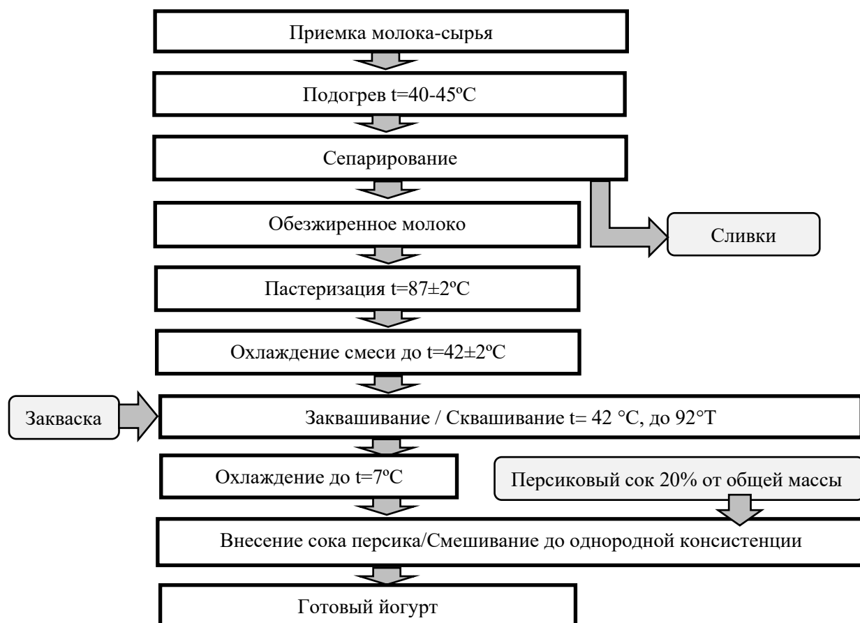
Рисунок 1. Технологическая схема получения йогурта, обогащенного соком персика
